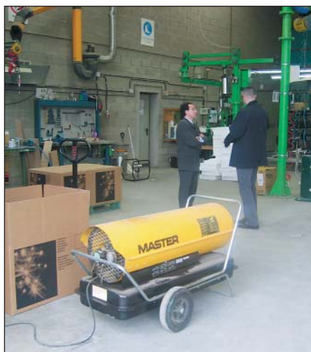
Fot. 2 Nagrzewnica olejowa bez odprowadzenia spalin
